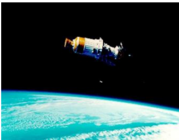
Figura 3: Ulysses inicia su peculiar periplo. La sonda solo ocupa el extremo derecho del conjunto. El resto son los módulos de propulsión IUS ( Inertial Upper Stage ) y PAM ( Payload Assisted Module ).
