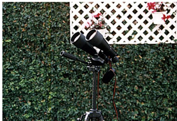
Figura 3: Binoculares de 9x63 sobre trípode. Cortesía Silvia Smith.
