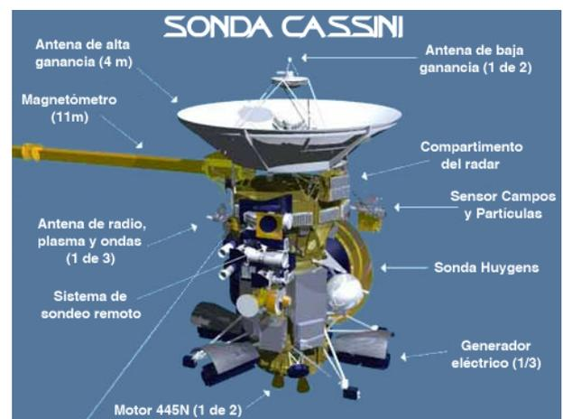
Figura 2: Instrumentos a bordo de Cassini. Cortesía NASA.
